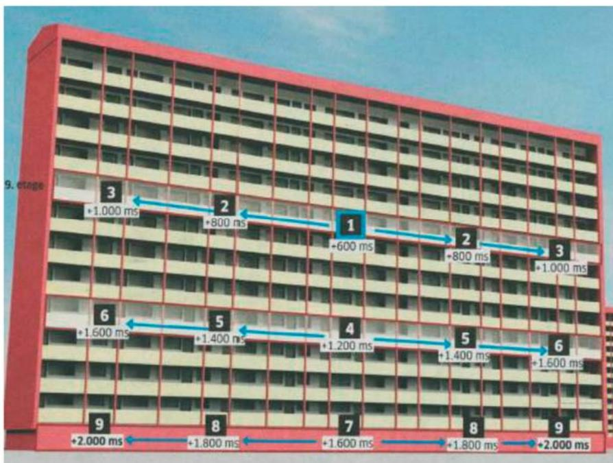
*Prinzip der Sprenganordnungen mit den Verzögerungsstufen von 1 (600 ms) bis 9 (2.000 ms)*
